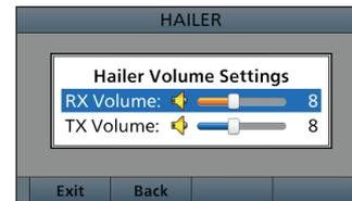
**HINWEIS:** Während des Megafon-Betriebs sind die Funktionen des Funkgeräts abgeschaltet. Die Megafon-Funktion lässt sich nicht einschalten, während das Funkgerät sendet.
